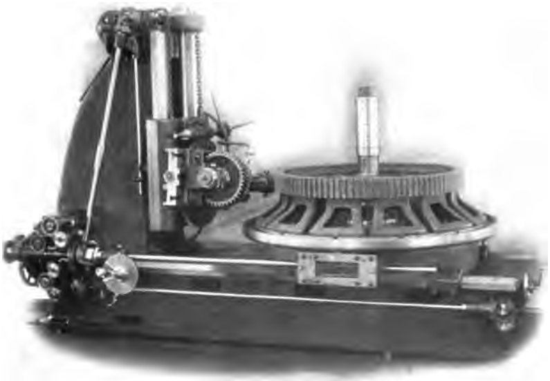
Fig. 23. Gear-Hobbing Machine. (Pfauter.)
