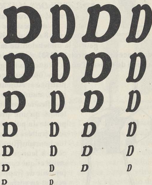
352. GROUPE DE LETTRES EXÉCUTÉES A LA MACHINE A GRAVER, AVEC LE MÊME « MODÈLE ».
