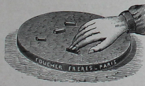
Fig. 95. — Pierre émeri dressée sur les deux faces, servant pour frotter les caractères fondus avec les machines ordinaires. 30 fr. Elle sert aussi pour dresser les blocs, les garnitures et les lingots.
